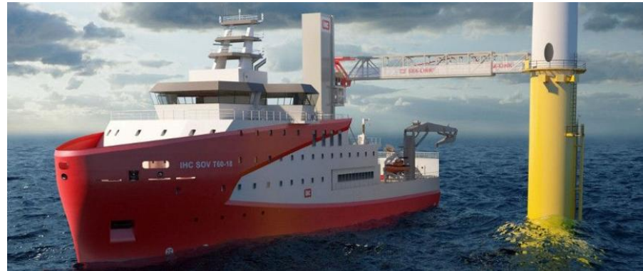
풍력터빈 시운전 및 운영단계, 작업자 및 부품장비 등 현장 이송, 약 60명 거주공간(작업자 40명), 국내 O&M사 미운영(2-3GW 단지당 1척)
